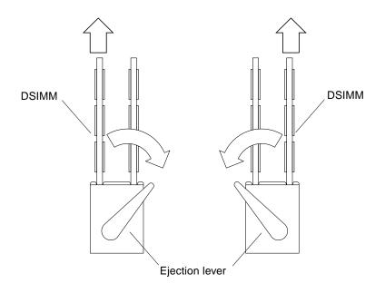
FIGURE 10-21 DSIMM Ejection Lever
