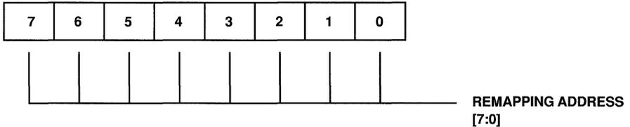
Figure D1-8. Extension Register GR9/GRA
