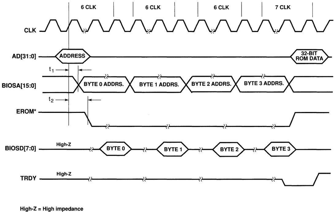
Figure 7-23. EROM\*, BIOSA[15:0] Timing (PCI Bus)
