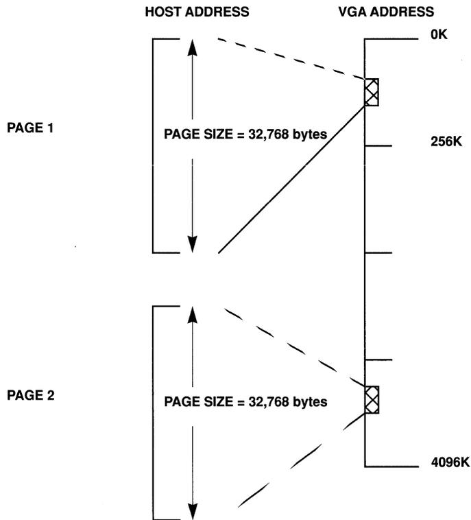
Figure D1-2. Dual-Page Mapping Scheme
