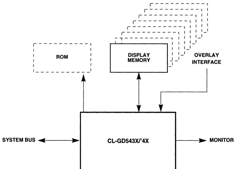
Figure 2-7. Video Subsystem Architecture
